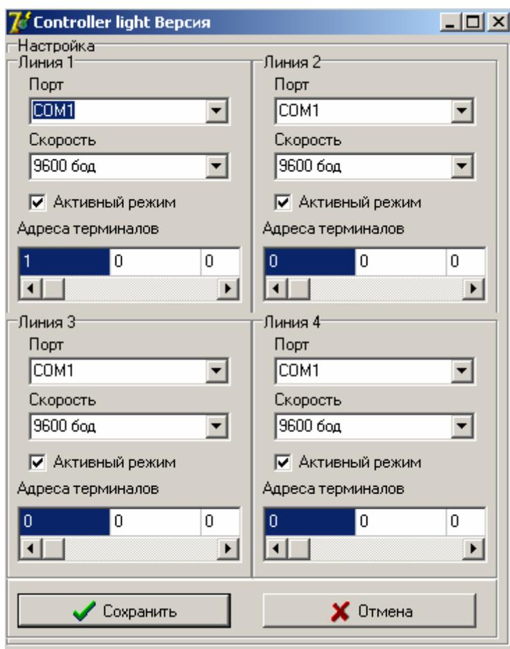
Далее необходимо произвести настройки четырех линий. Каждая линия представляет собой совокупность терминалов. На каждую линию можно подключить до 30 различных весовых терминалов, если используется 485 интерфейс и 1 весовой терминал в случае использования интерфейса 232.
