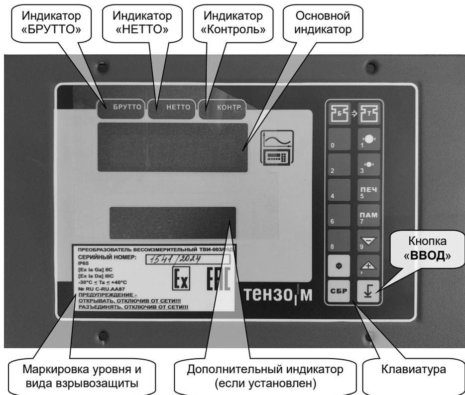
Рис. 8.1. Внешний вид Преобразователя спереди.
