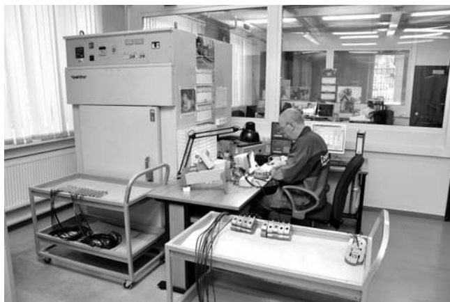
Рис. 6. Рабочее место на участке нормирования параметров тензодатчиков
