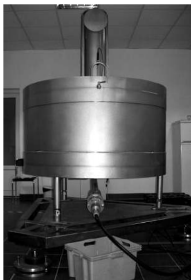
Рис. 13. Высокоточные платформенные весы ВСПМ с мерником
