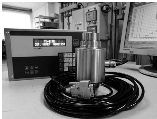
Рис. 7. Цифровой тензодатчик МВЦ и весовой терминал ТЦ-017
