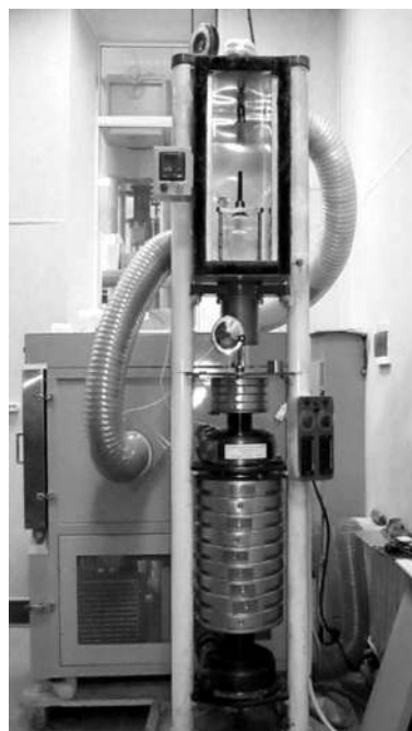
Рис. 11. Температурная камера для испытаний тензодатчиков
