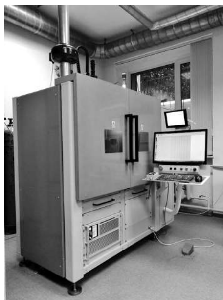
Рис. 18. Машина лазерная «МЛ4 Компакт» с оптоволоконным лазером
