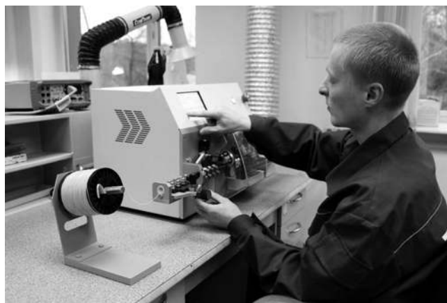
Рис. 17. Машина для автоматической мерной резки и зачистки проводов
