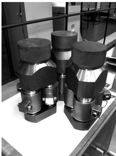
Рис. 10. Компаратор силы на 9 МН
