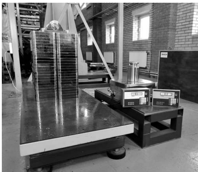
Рис. 12. Компаратор на 2 т и эталонные меры массы класса F2
