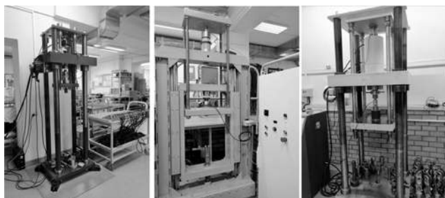
Рис. 19. Новые гидравлические эталонные силозадающие машины (слева направо): СМ-50, ЭСМГ-50 кН, ЭСМГ-500 кН
