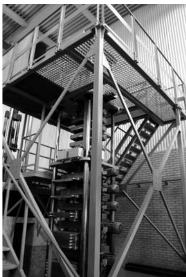
Рис. 20. Эталонная силозадающая машина ОСМ-2-200
