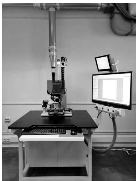
Рис. 16. Станок лазерной разметки упругих элементов
