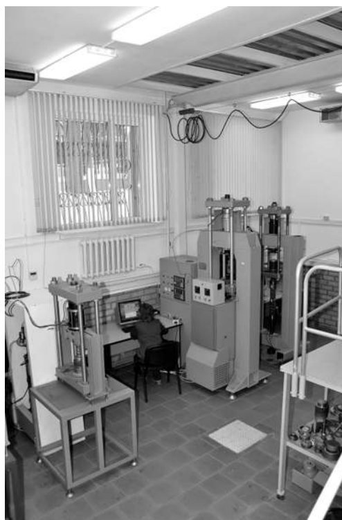
Рис. 3. Проверка функционирования гидравлической машины ЭСМГ-50 на 50 т
