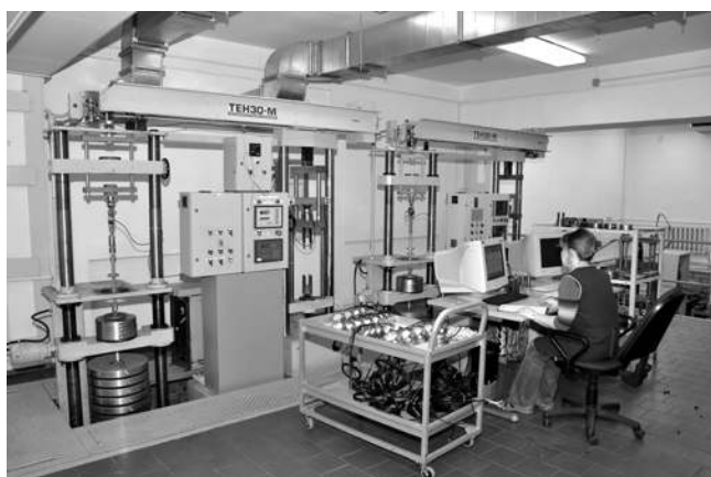
Рис.1. Эталонные рычажные машины типа ЭСМР на 5 т и 50 кН
