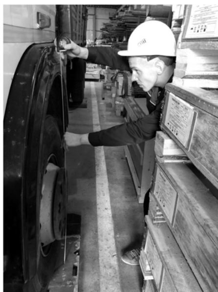
Рис. 7. Измерение вертикального хода подвески, деформации шины и осевой нагрузки в процессе нагружения кузова гирями
