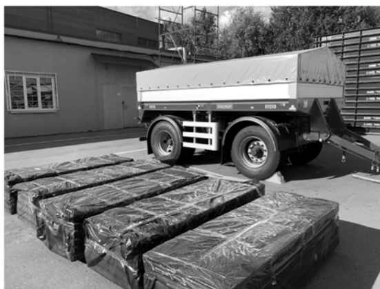
Рис. 11. Эталон динамической осевой нагрузки (ЭДОН) с набором эталонных грузов
