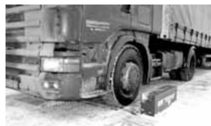
Рис. 11. Взвешивание большегрузного ТС в движении на весах типа «В»
