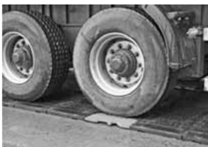
Рис. 8. Измерение осевых нагрузок ТСПП портативными подкладными весами «П»
