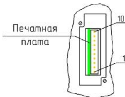
Рисунок Г.1 – Нумерация 10-и контактного разъема Weidmuller
